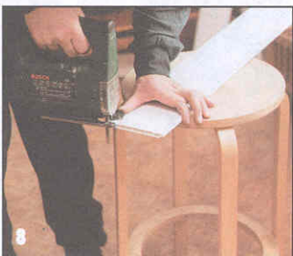
8 Электророботиком опилил торец панели по линии разметки.
